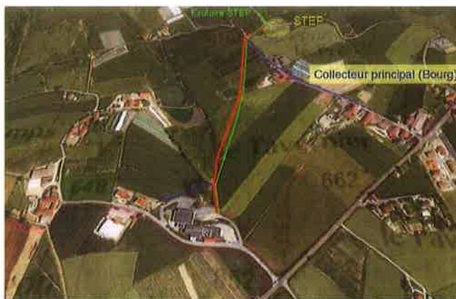
canalisation béton conservée en exutoire eaux pluviales canalisation en fonte (eaux usées)
